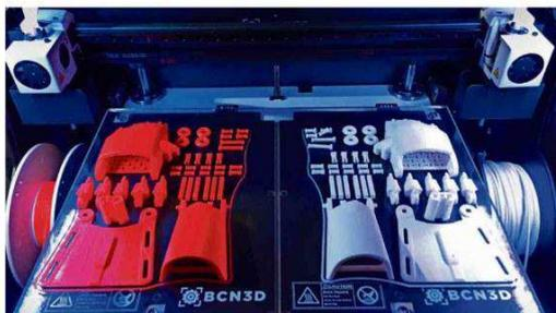
Teile für zwei Hände aus dem 3-D-Drucker: Der rote und der weiße Kunststoff von den Spulen (links und rechts) werden erhitzt und über die Düsen (oben) aufgespritzt.
